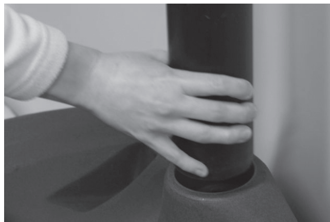
3. Lossning av ventilationsröret.
